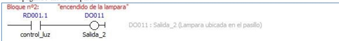
Cada vez que se presione el pulsador el estado de la variable cambiará puesto que hemos utilizado la función “TOGGLE”, y por lo tanto también cambiará el estado de la lámpara, hasta que se vuelva a presionar de nuevo el pulsador.
